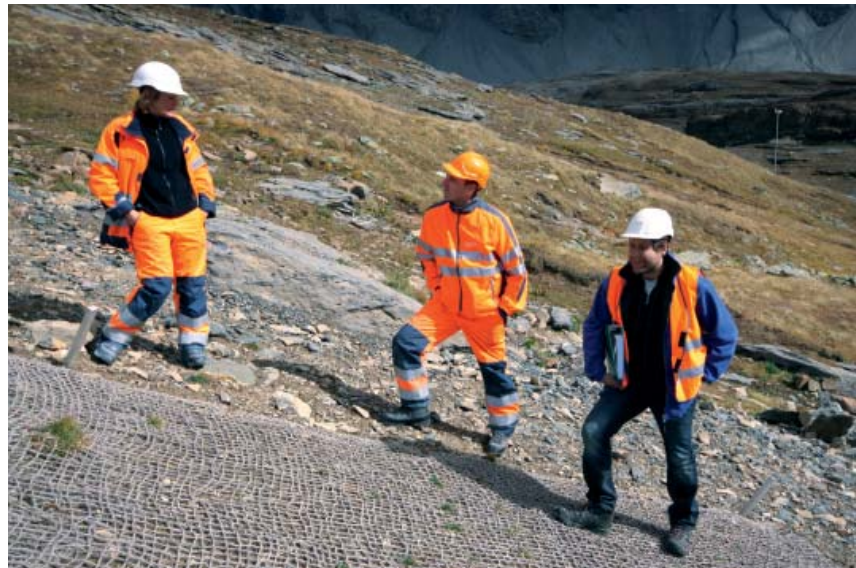
Bild links: Anpflanzung auf der Versuchsfläche im Obersand auf ca. 1900 m. Bild rechts: Versuche bei «Mast 4»: Markus Schutz (r.) begutachtet eine mit Geotextil (Kokosfasern) abgedeckte, angepflanzte Fläche.
